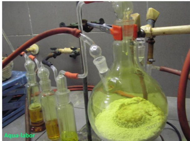
Anschluss für CO 2 Spülung
