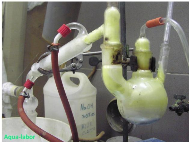
Die \text{PCl}_5 - und gelber Phosphorablagerungen können später gefährliche Verstopfungen verursachen
