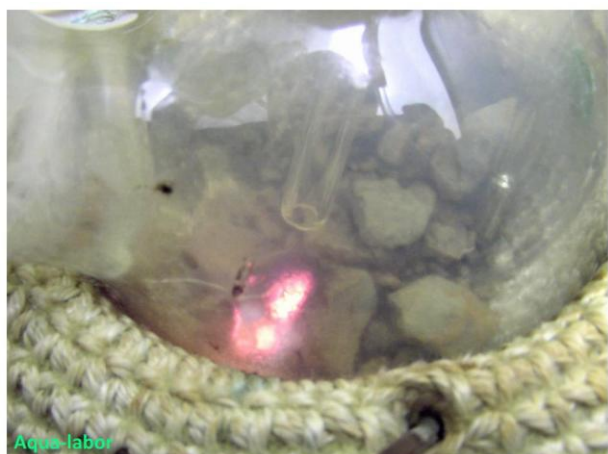
Wenn die Chlorströmung zu schnell ist, der Phosphor sofort beginnt zu glühen.
