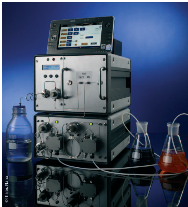
Die Firma Thales möchte im Durchflussreaktor heterogene Katalyse mit Mikrowelleneffekten kombinieren.
