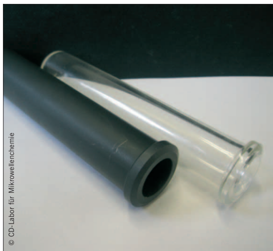
Anstatt Glas- (im Bild rechts) könnte man in der Mikrowellenchemie auch Gefäße aus Siliciumcarbid (links) verwenden.
