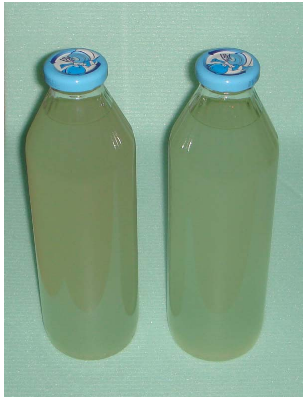
Nach 15 Minuten hat sich bereits Chloroform am Boden gesammelt und die Lösung ist grünlicher geworden.
